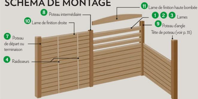
Clôture modulaire économique composée de lames et poteaux en bois du Nord massif traité classe 4. Les lames s'insèrent dans les rainures des poteaux. 4 modèles de lames pour de multiples combinaisons.
