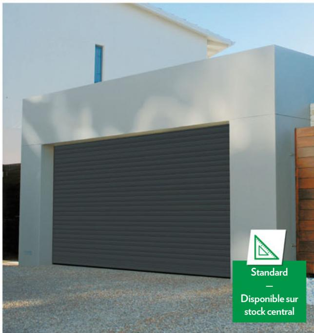
Porte de garage à enroulement avec tablier en lames aluminium de 77 mm et 19 mm d'épaisseur. Coffre de 300 mm en aluminium et coulisses de 110 x 35 mm. Pose en applique intérieur derrière linteau. Verrouillage automatique et antichute + manœuvre de secours intégrée.
