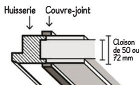
**Huisserie 72 mm** : pour cloison de 50 mm ou 72 mm avec couvre-joint supplémentaire.
