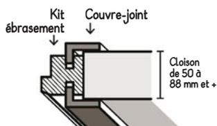
**Porte + kit ébrasement** : ou kit chambranle/contre-chambranle pour pose en fin de chantier.
