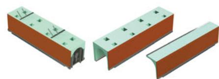
Lame alu extérieure avec profil finition PVC blanc à clipper isolation acoustique (largeur 280 mm) : Dn,ew : 50 (C : -2 ; Ctr : -6) dB. Coefficient de transmission thermique (largeur 280 mm) : 0,64 W/m².K. Enroulement extérieur.
